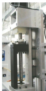
Recorrido del tampón accionado por un servomotor
